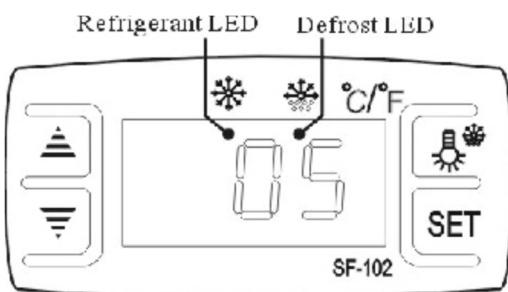
1. Regolare la temperatura: premere il pulsante **SET**, viene visualizzata la temperatura impostata. Premi il bottone **▲** Dove **▼** per modificare e memorizzare il valore visualizzato. Premi il bottone **SET** per uscire dall'impostazione e visualizzare la temperatura della cella.
